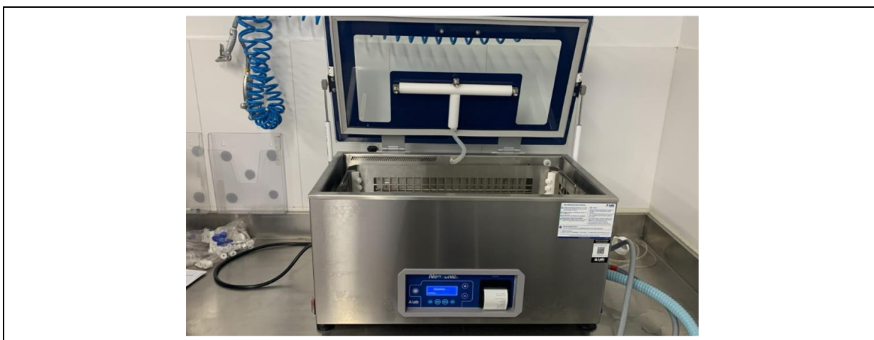
Figura – Instalação de Lavadora Ultrassônica Nova
